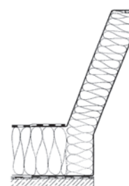
Podsada JET z kompozitu ocel-hliník Typ P vysoká 40 cm
