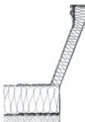
Kovová podsada JET typu TE, vysoká 40 cm s upínací lištou
