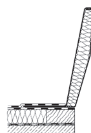
Podsada JET z kompozitu ocel-hliník pro RWA typu RAK, vysoká 30 cm
